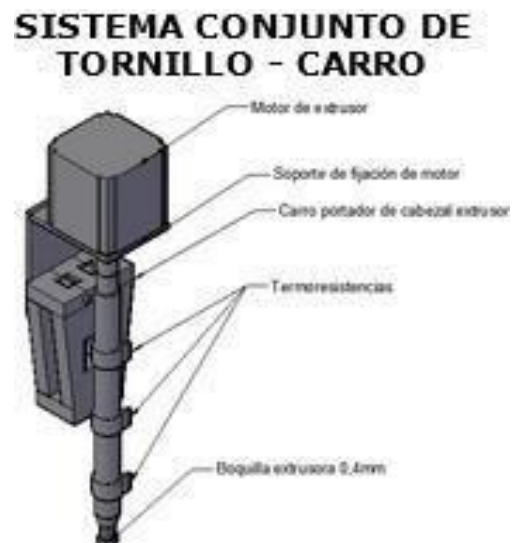
Gráfica N° 3. Conjunto tornillo extrusor-carro porta extrusor.
