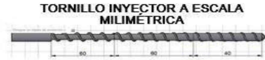
Gráfica N° 2. Diseño teórico de tornillo inyector a escala milimétrica.
